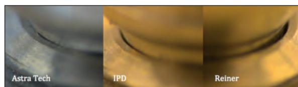
Figura 2 Visión a microscopía óptica de la fase implante-pilar.
